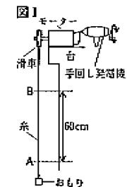
【実験1】図Iのように、台に固定したモーターに手回し発電機をつなぎ、糸につるした質量0.14kgのおもりを引き上げる装置を作った。手回し発電機のハンドルを回すとモーターに電流が流れ、モーターに取り付けた滑車が回転して糸を巻き上げ、おもりが上昇した。おもりの運動のようすをデジタルカメラで撮影して調べたところ、おもりの上端が、図I中のAの高さを通過してからBの高さを通過するまでに4秒かかるており、この間、おもりの上昇する速さは一定であったことがわかった。また、AとBとの高さの差は60cmであった。
